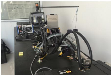
图 13 残余应力测试仪
