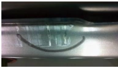
图1 RP153-980B 冷轧高强度钢板冲压拉毛缺陷
